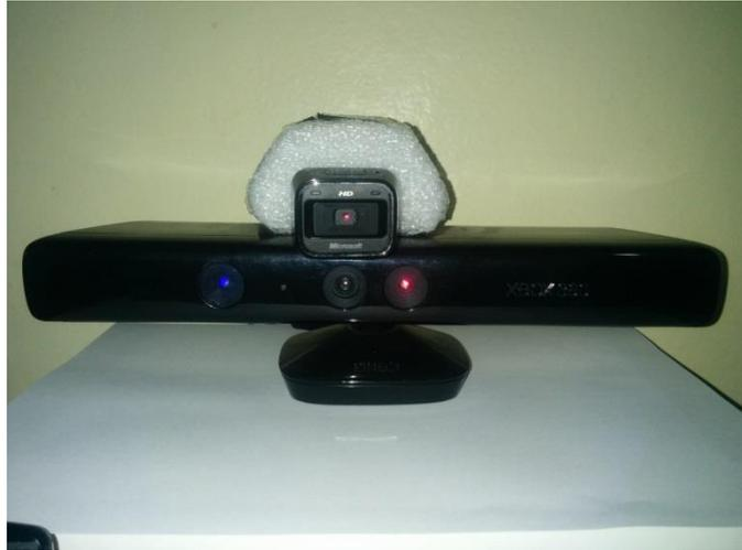
Figura 3.8 Montagem câmera e sensor kinect.
