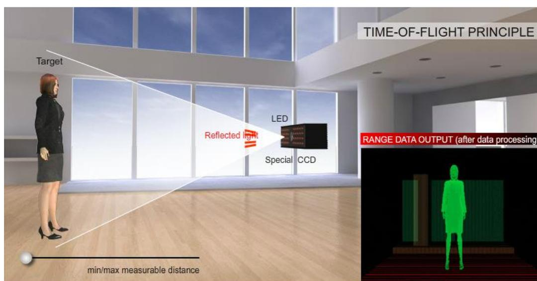
**Figura 2.5 - Exemplo de imagem sendo obtida por câmera infravermelho, retirada de [http://www.epnc.co.kr/at1/view.asp?a\_id=9458]**
