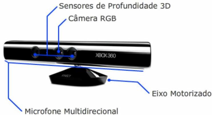
**Figura 3.1 - Sensor kinect e suas funcionalidades, retirada de**
