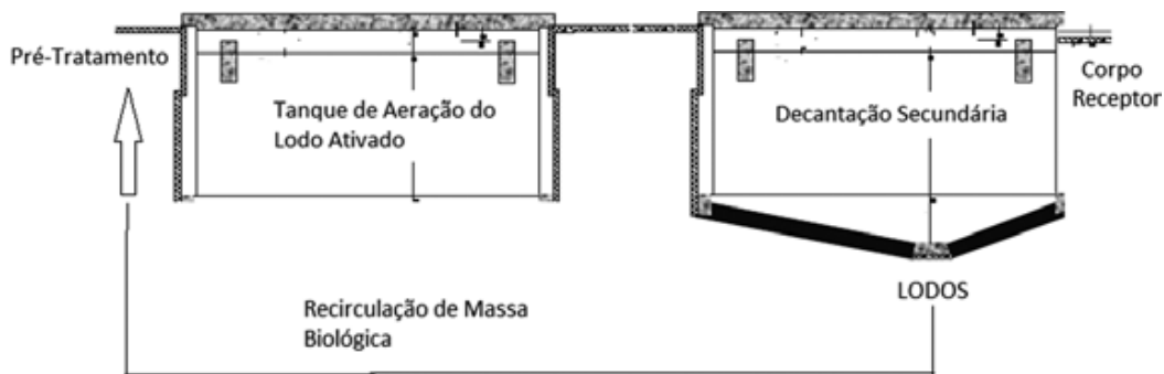
FIGURA 60 – LODOS ATIVADOS E DECANTAÇÃO SECUNDÁRIA
