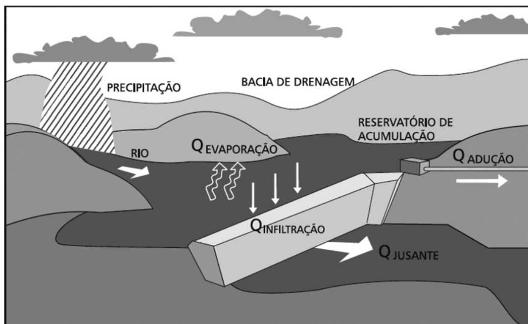
FIGURA 29 – ESQUEMA TÍPICO DE UM RESERVATÓRIO DE ACUMULAÇÃO
